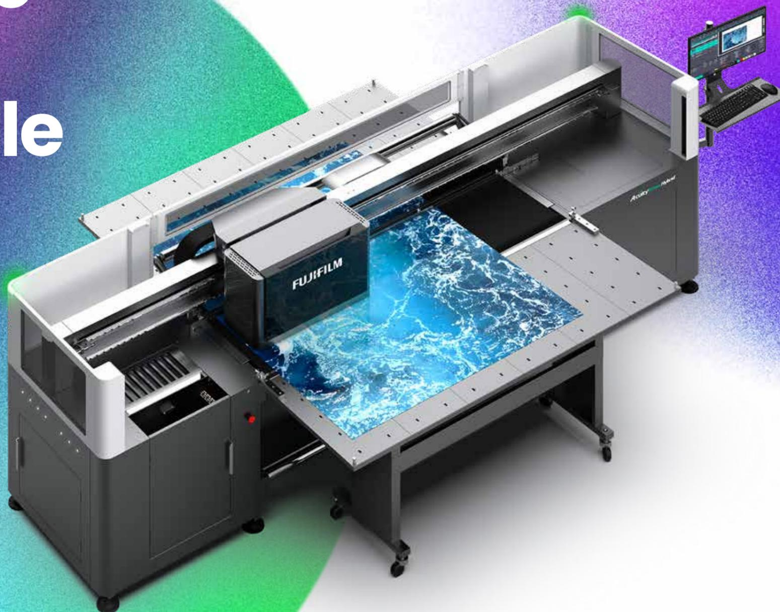
Acuity Prime Hybrid può essere configurata con un massimo di 7 canali (CMYK di serie e bianco, trasparente e primer in opzione) per produrre stampe di qualità straordinaria, con dimensioni delle gocce ridotte fino a 7 pl. Gestisce supporti flessibili e rigidi fino a 51 mm di spessore e bobine di larghezza fino a 2 m; inoltre, trae vantaggio da un sistema di polimerizzazione UV LED raffreddato ad aria affidabilissimo e di lunga durata.
